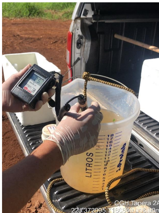
CGH Tapera 2A 22J 372095 7180640 ±16.00m Figura 13 - Profissionais da Forte realizando a medição de temperatura da água na CGH Tapera 2A.
