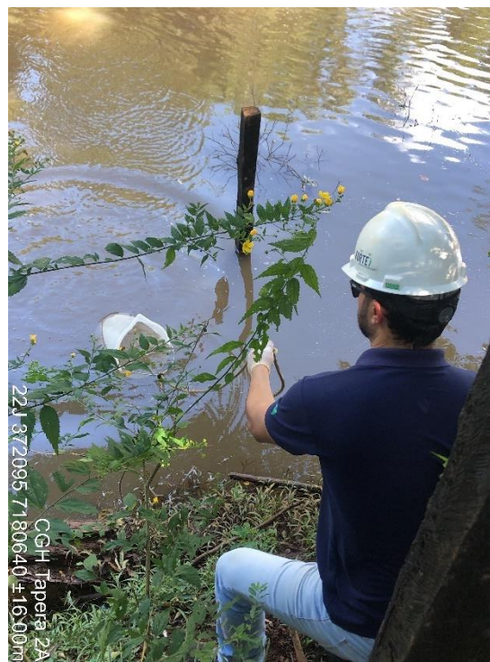
Figura 8 - Profissional da Forte realizando a coleta da água na CGH Tapera 2A.
