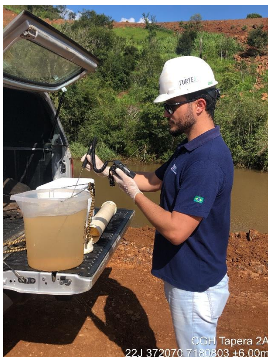
Figura 10 - Profissionais da Forte realizando a medição de temperatura da água na CGH Tapera 2A.
