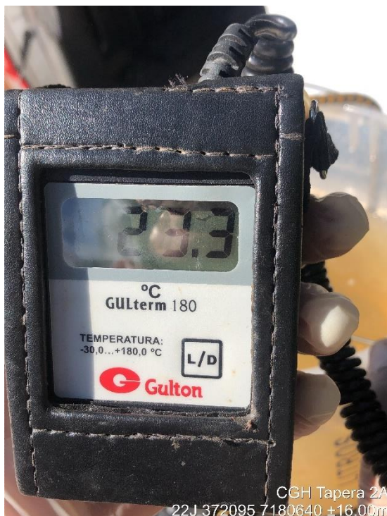
CGH Tapera 2A 22J 372095 7180640 ±16.00m Figura 14 - Profissionais da Forte realizando a medição de temperatura da água na CGH Tapera 2A.
