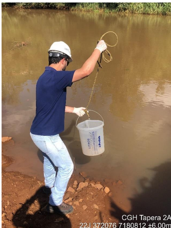
Figura 3 - Profissional da Forte realizando a coleta da água na CGH Tapera 2A.
